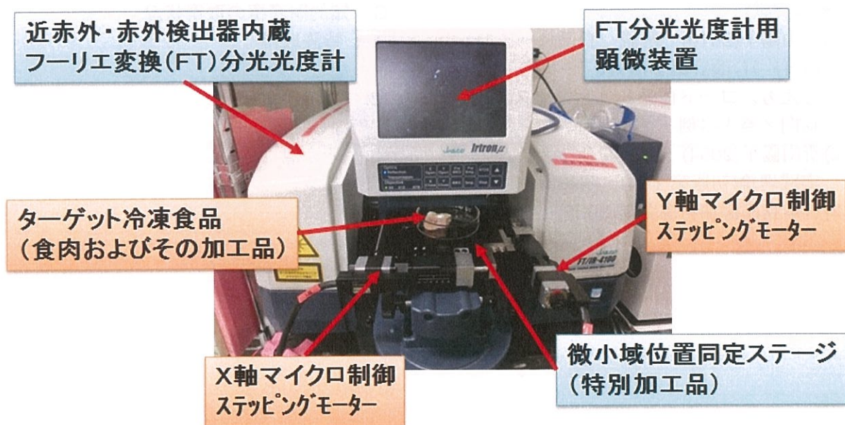
図1 微小域位置同定ステージを用いた表面反射分光測定の概要
