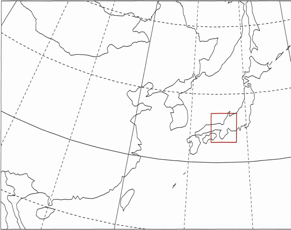
図1. 計算領域。東西 4500km、南北 3600km、水平解像度 90km の領域 1 (黒枠) と、東西南北 450km、水平解像度 9km の領域 2 (赤枠) を結合した。
