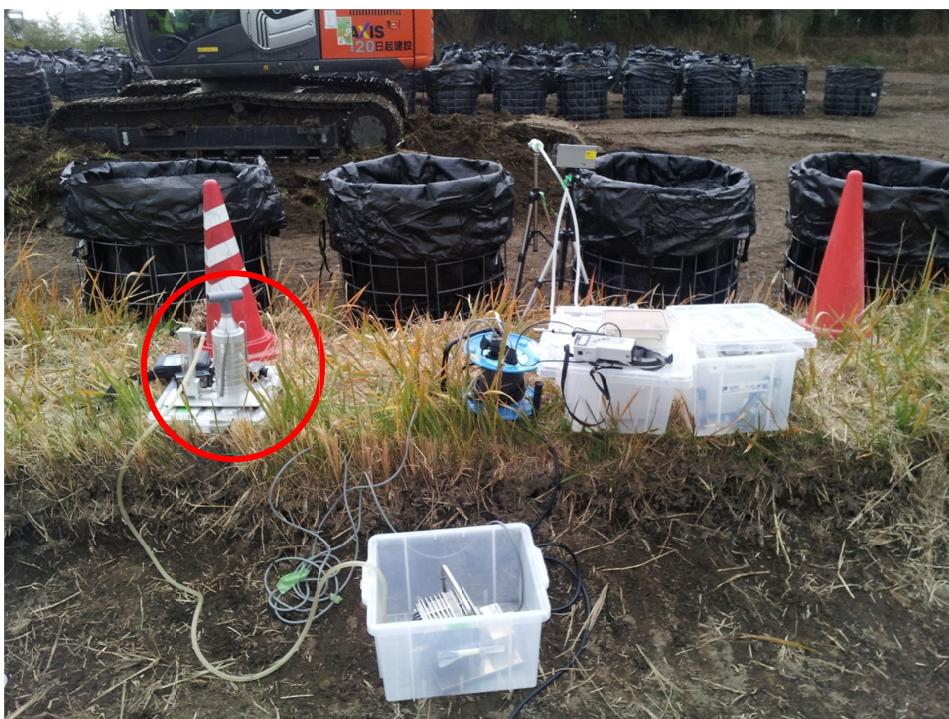
写真2 定点における粉じん計測（赤丸はアンダーセンサー）
