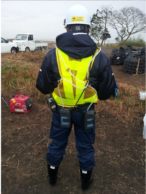
写真 3・4.個人ばく露測定のための装備（研究員）
