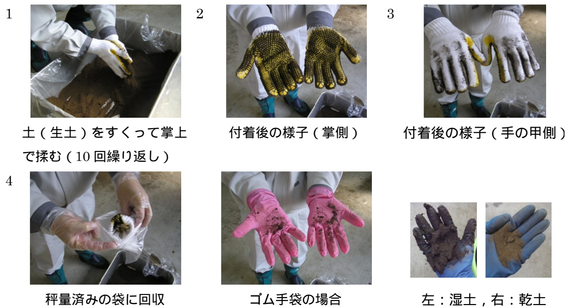
図 3 手袋への土壌付着試験の手順
