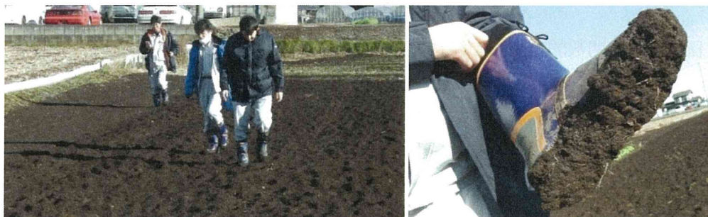
図5 降雨後の畑での歩行試験の様子（左）と靴底への土の付着の程度の一例（右）
