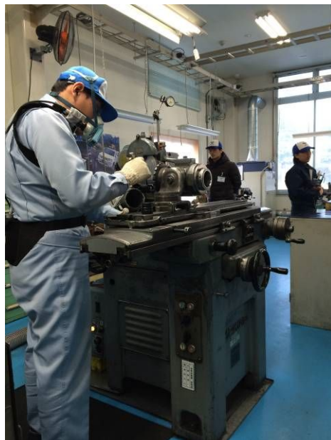
図 6.5 研磨作業の作業状況
