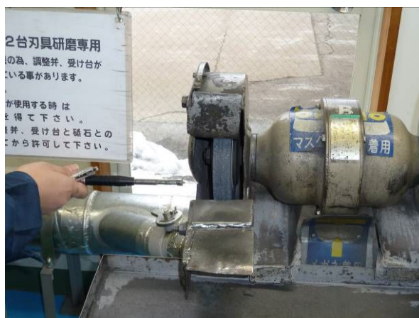
図 6.12 キャノピー式フード開口面における吸引速度測定状況
