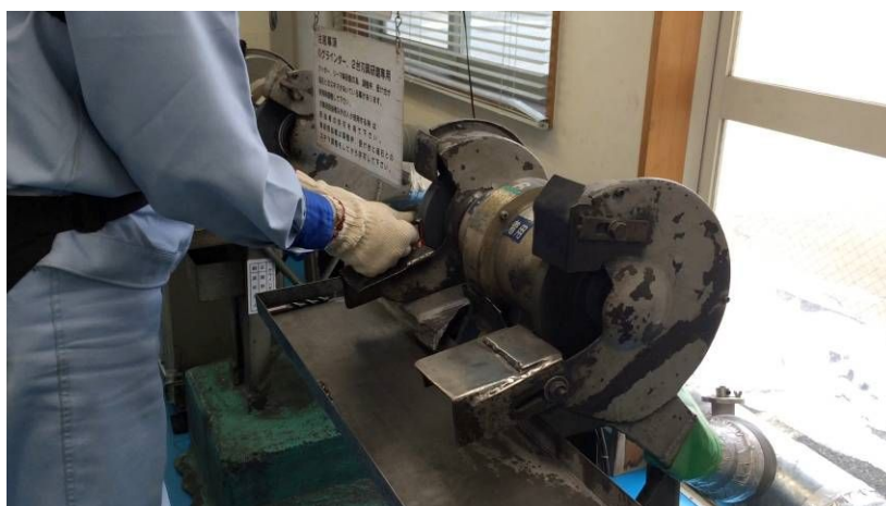
図 6.11 粉じん漏洩濃度測定時の研磨作業状況
