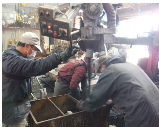
図 1.3 手込め作業風景
