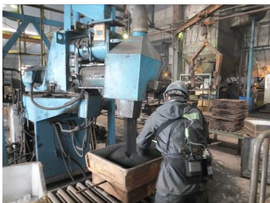
図 1.5 手込め作業風景
