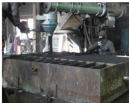
図 1.4 手込め作業風景
