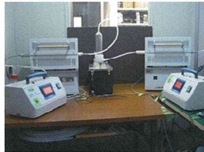
写真 130 有機質・無機質除去処理装置の概要（全景）
