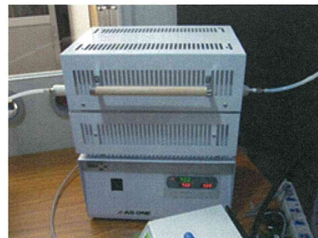
写真 131 有機質繊維除去処理装置の概要（電気炉部分）
