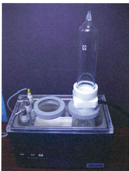
写真 103 無機質繊維除去装置の外観
