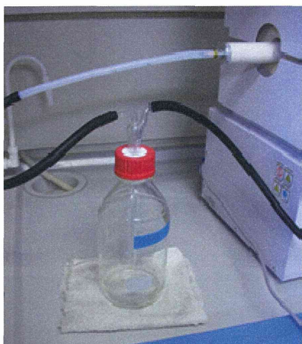
写真 106 サンプルング系統図 (冷却部分：液滴トラップ)
