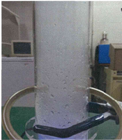
写真 100 ギ酸ミスト混合部分の内壁の状況
