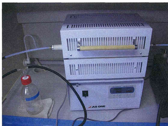
写真 105 サンプルング系統図 (加熱装置：改造型管状電気炉)
