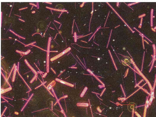
写真 38 ロックウール 450°C (浸液 : 1.620 100 倍)
