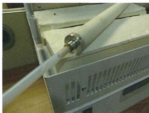
写真 73 改造した炉心管の先端の外観
