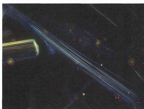
写真 31 クリタイル 500°C (浸液: 1.550 400 倍)
