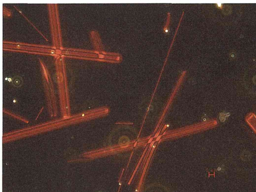
写真 45 ロックウール 700°C (浸液 : 1.620 400 倍)
