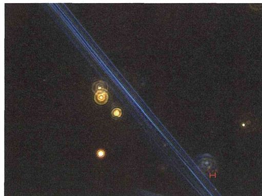
写真 29 クリタイル 450°C (浸液: 1.550 400 倍)
