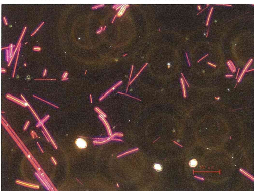
写真 40 ロックウール 500°C (浸液 : 1.620 100 倍)
