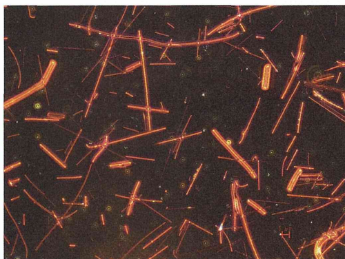
写真 44 ロックウール 700°C (浸液 : 1.620 100 倍)
