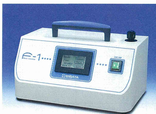
写真 69 ファイバーエアロゾルモニター F-1（柴田科学㈱製）の外観
