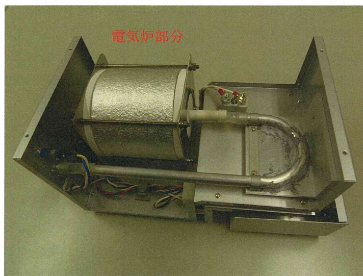
写真 70 市販の有機質除去処理装置の加熱部分の概要
