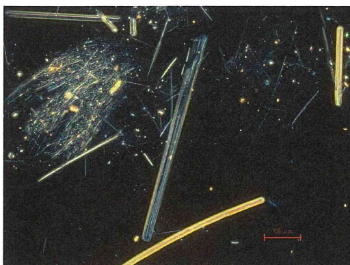
写真 34 クリソタイル 700°C (浸液 : 1.550 100 倍)
