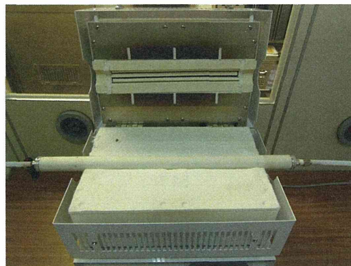
写真 72 管状電気炉の加熱部分の外観
