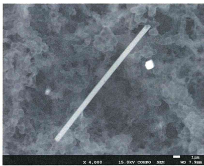
写真15 解体現場3の電子顕微鏡写真と繊維状粒子の同定結果
