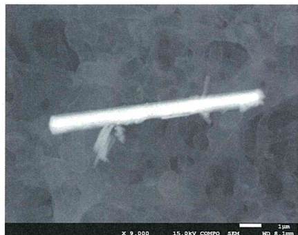
写真 12 解体現場 1 の電子顕微鏡写真と繊維状粒子の同定結果
