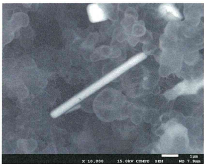
写真16 解体現場3の電子顕微鏡写真と繊維状粒子の同定結果
