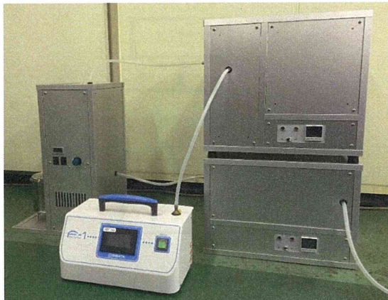
写真 54 有機質・無機質除去処理装置の外観
