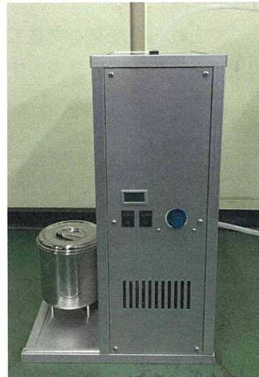
写真 56 無機質繊維除去処理装置の外観 (ギ酸ミスト発生装置部分)
