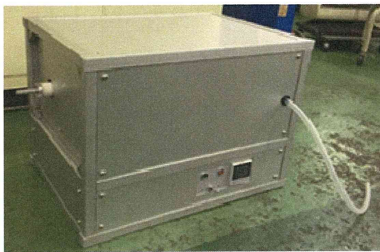
写真 55 有機質繊維除去処理装置の外観 (電気炉部分)
