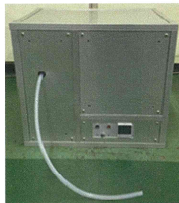
写真 57 無機質繊維除去処理装置の外観 (電気炉部分)
