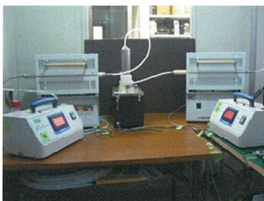
写真10 有機質・無機質除去処理装置の概要（全景）
