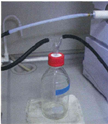
写真6 サンプルング系統図 (冷却部分：液滴トラップ)
