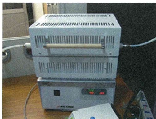
写真11 有機質繊維除去処理装置の概要（電気炉部分）
