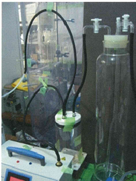
写真9 発生装置からサンプリングポートまでの概要
