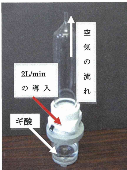
写真2 ミストの発生部分の外観
