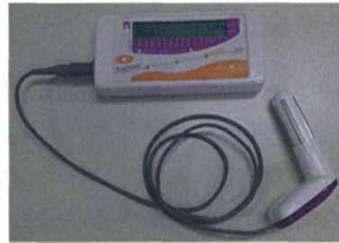
図2 クリニック用筋電図バイオフィードバック機器 (MegaElectronics社製, FemiScan Clinic System)
