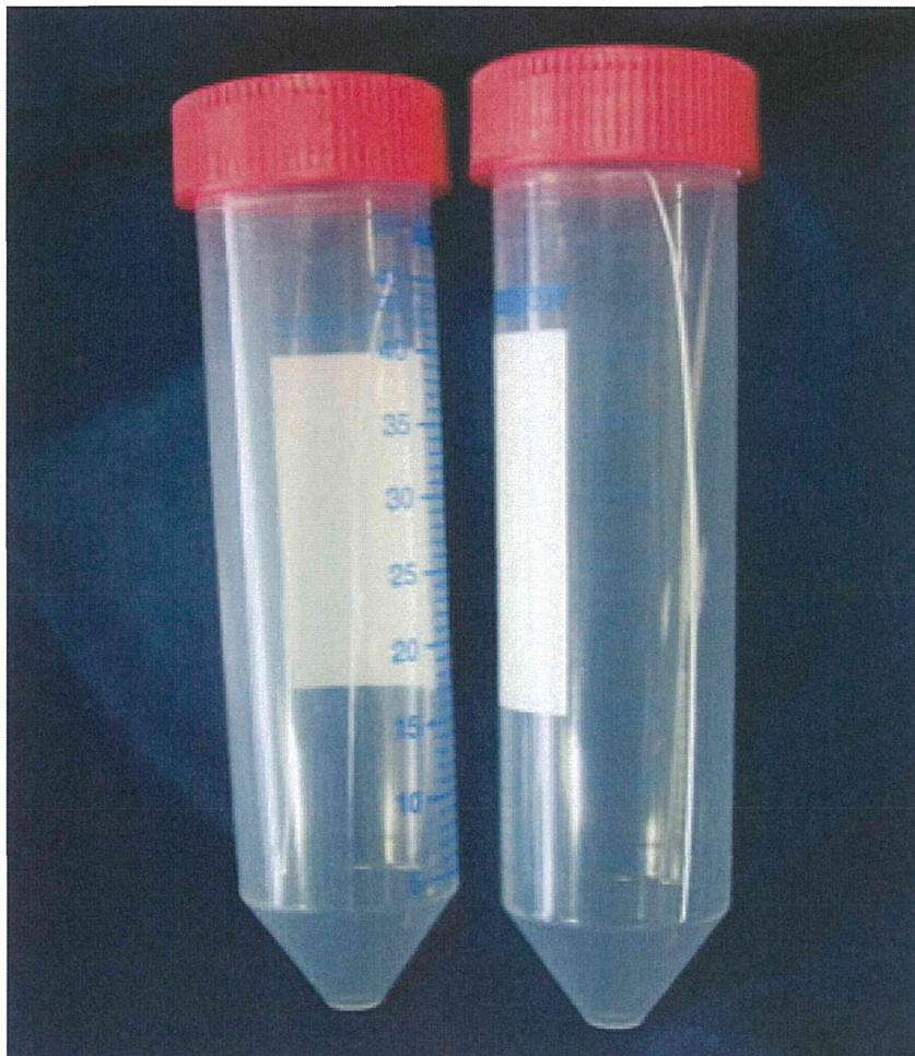
* 破損したアシストチューブ（縦に複数の亀裂がある）
