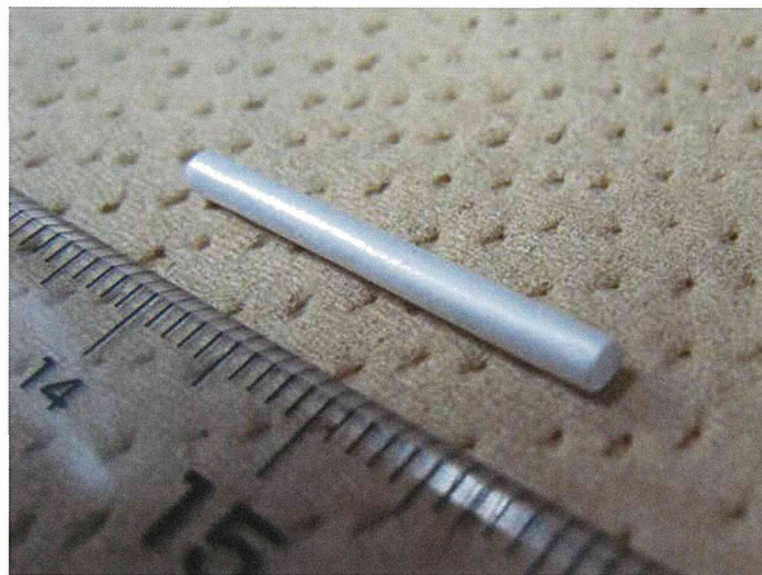
図 3 4. 配向性ポリ L-乳酸マイクロファイバーを内層にもつチューブの試作 (A) チューブ作製に用いた装置 (B) 試作したチューブ
