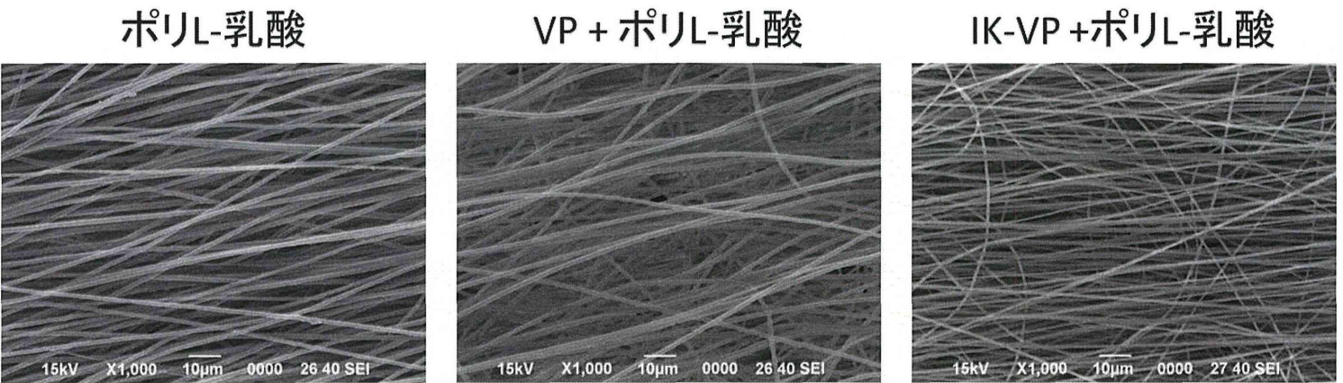
図41. ポリ-L-乳酸および、VPもしくはIK-VPとポリ-L-乳酸との混合マイクロファイバーとそのCell Culture Slideへの固定 ( In vitro 実験用)
