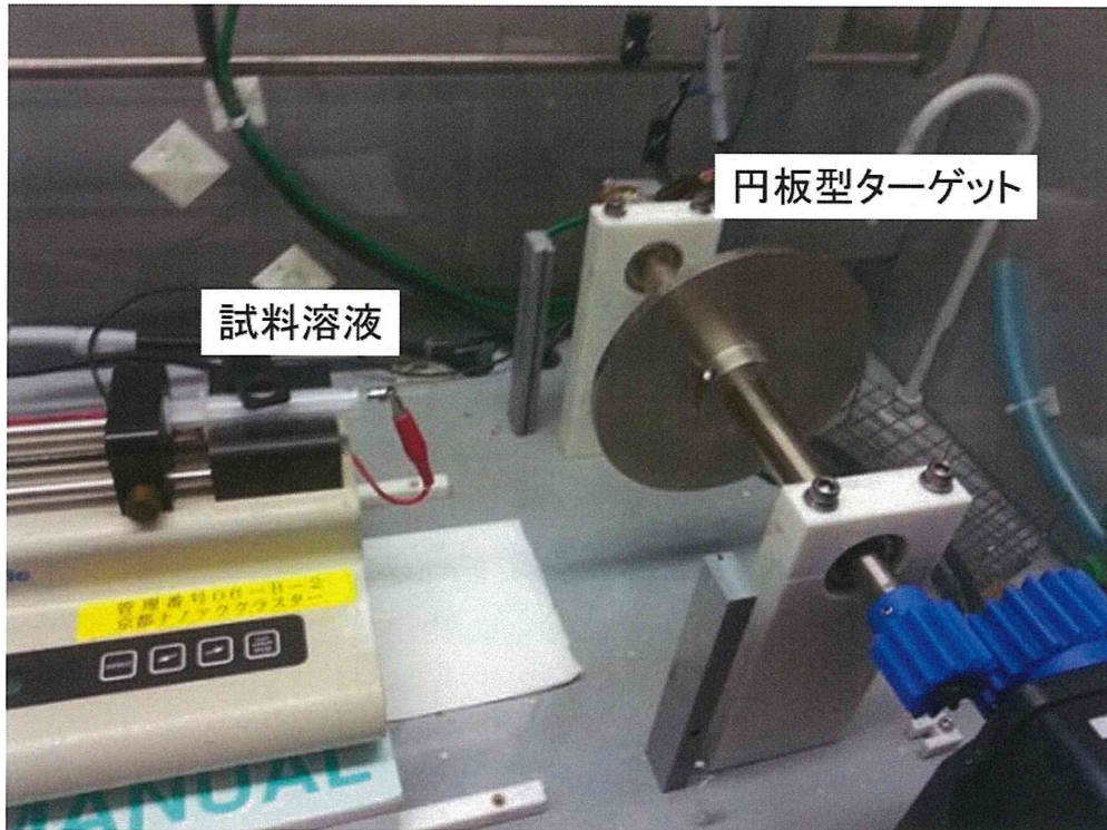
図7. 円板型ターゲットを用いた電界紡糸装置
