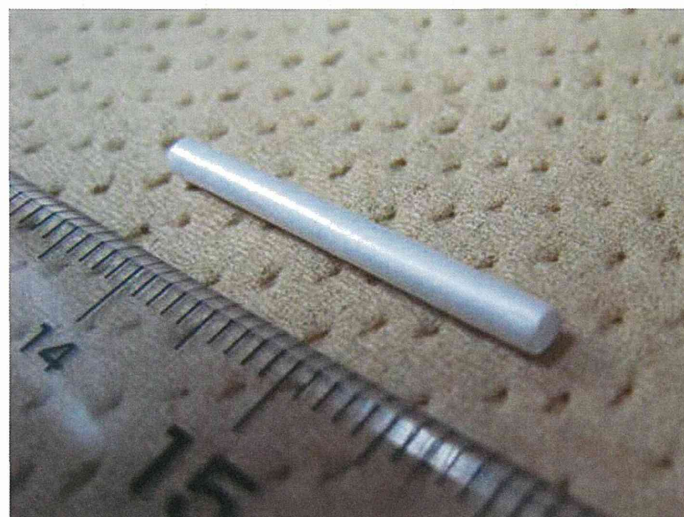
図10. 配向性ポリ L-乳酸マイクロファイバーを内層にもつチューブの試作 (A) チューブ作製に用いた装置 (B) 試作したチューブ
