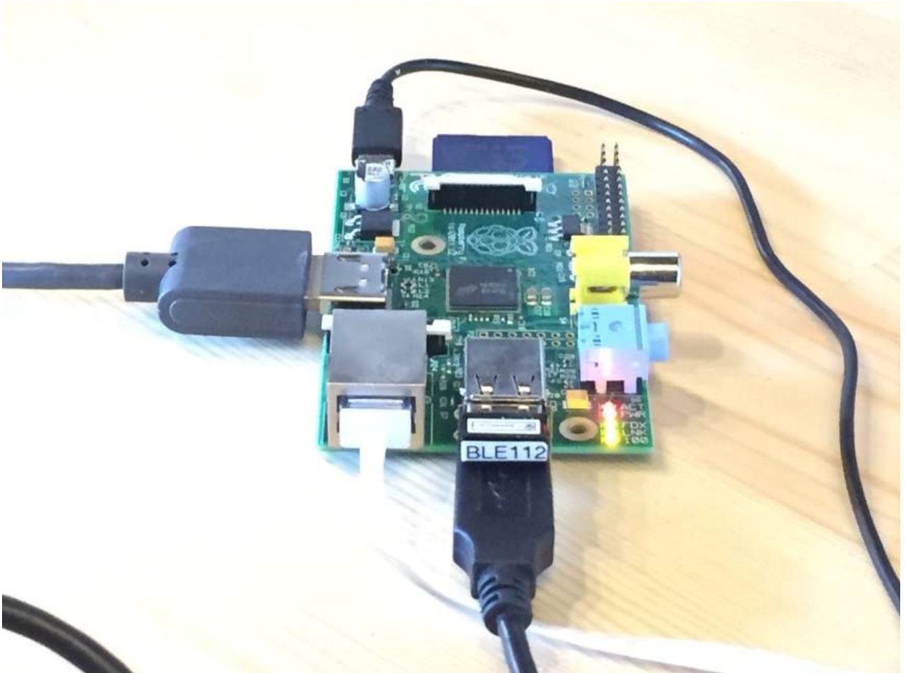
図 8 . CPUをRaspberry pieに変更したBLEボード .
