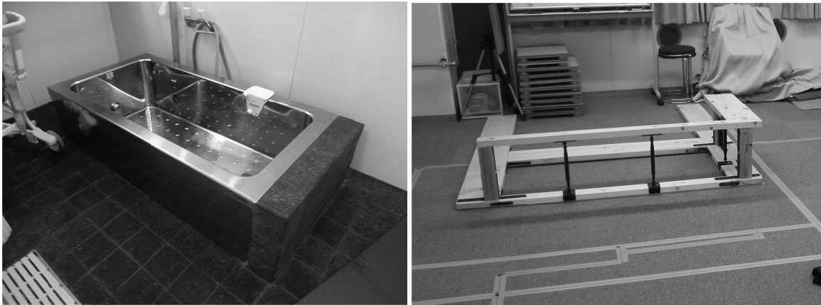
図8 実際の浴槽(左)と浴槽のモックアップ(右)
