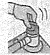
①ガスの元栓を閉める ※最近元栓の無いタイプもある
