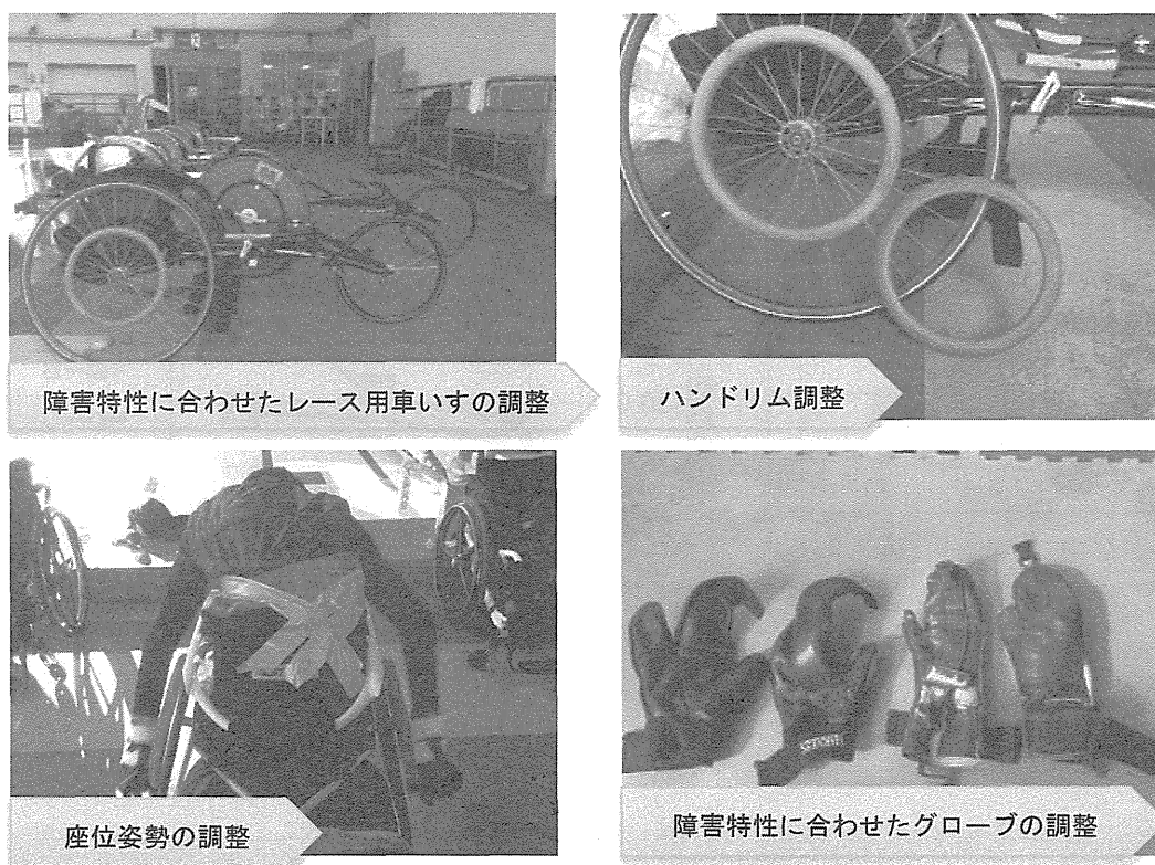
図 6. レース用車いすに関する調整 (例)
