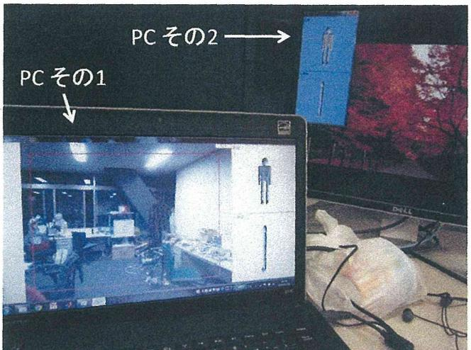
は、頭部・胸部・両肩・両肘・両手関節・両手部・腰部・骨盤・両股関節・両膝・両足関節・両足部の合計20箇所の位置情報の経時的变化のみを取得、送信するため、ビデオカメラで記録した動画に比して約1/20のファイル容量 [例: 動画=160MB/2分間 (720×480, 0.6Mbps; 本開発=8MB/2分間)]である。したがって、インターネット環境にほとんど依存せず、遠隔地でのreal-time運動情報取得が可能となった。また、動画が配信されないことにより患者/高齢者の自宅内部の様子や服装を遠隔地にいる医療者に見られることがなくプライバシー保護ができる。
