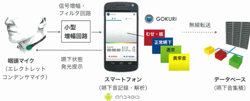
図 D-1. スマートフォン(android携帯)による嚥下音実時間解析およびデータ収集システムの概要図
