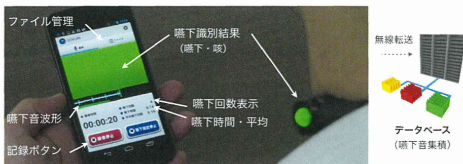
図 C-1-3. スマートフォンによる嚔下音実時間解析およびデータ収集システムの概要図
