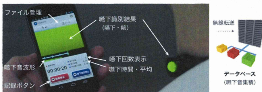
図 2. スマートフォン(android 携帯)による嚙下音実時間解析およびデータ収集システムの概要図
