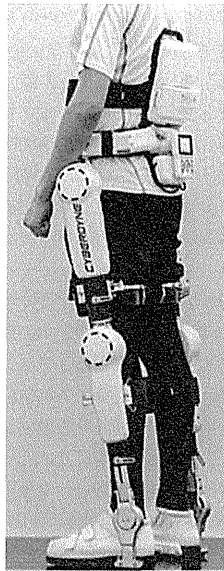
図1 HAL ® 下肢用 medical (ヨーロッパ用, http://www.cyberdyne.jp/products/LowerLimb_medical.html )
