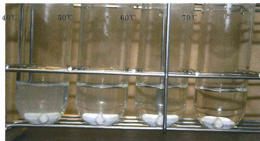
図 4 : P092・2 マレイン酸塩 加温温度と溶解状態
