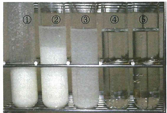
図 2:エタノール溶媒(99.5%)での溶解性確認結果
