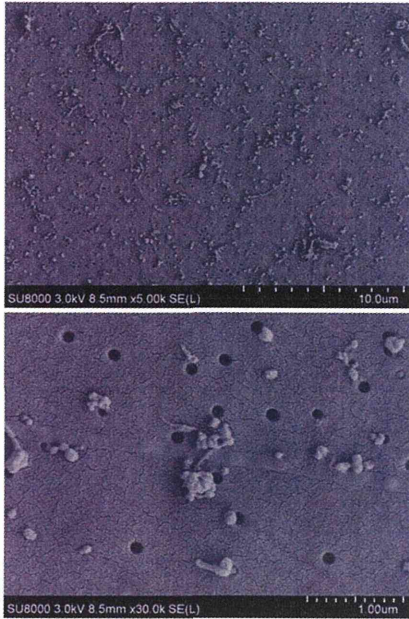
図4. 32 mmφのCoCr骨頭と組み合わせたCLPE+Eライナーから発生した摩耗粉（100万回）
