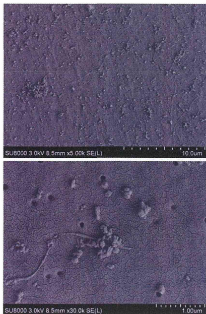
図5. 32 mmφのCoCr骨頭と組み合わせたCLPE+Eライナーから発生した摩耗粉（1000万回）
