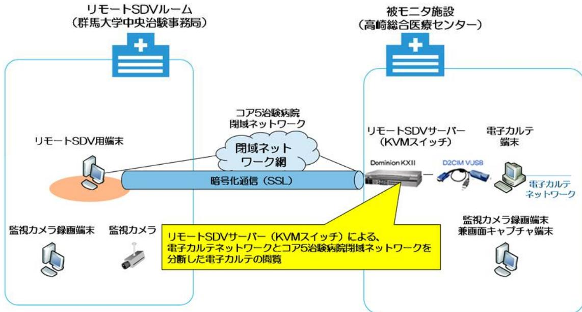
本システムはリモート SDVクライアントがコア5治験病院閉域ネットワークを経由し、電子カルテ端末と RGB/USB 接続されたリモート SDV サーバー ( KVM スイッチ ) に接続します。
