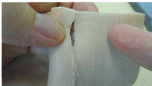
(図 24 : 改良第 4 次試作 (亀裂発生部) )
