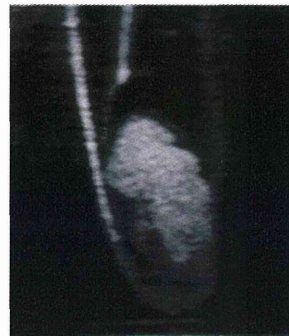
図106 復水処理後の凍結乾燥RGD-バブルリポソームの超音波造影能
