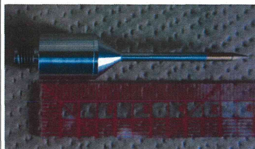
図5 AIMSで使用したハイドロホン 型名ONDA HNC-0400
