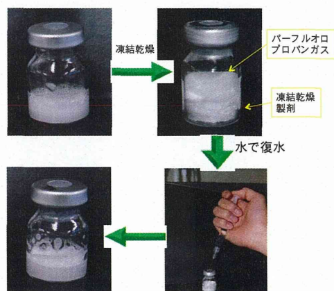
図2 RGD-バブルリポソームの凍結乾燥製剤の形態と凍結乾燥前と復水処理後の形態の比較
