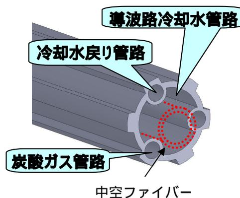
中空ファイバーの内径を 530  $\mu\text{m}$  にしたことで、スコープ先端での屈曲が可能になった(図 5)。
