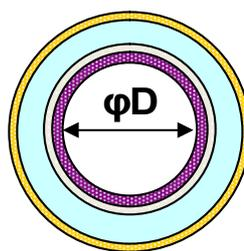
図 3：内径 530  $\mu\text{m}$  中空ファイバー(我が国独自技術)
