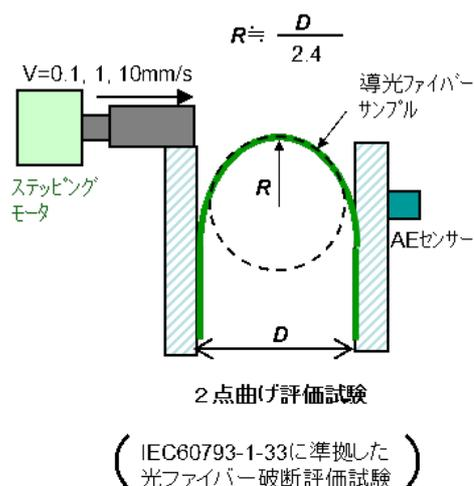
し破断する曲げ応力にばらつきをもたらすため、界面欠陥を抑制する製造プロセスの改良とともに曲げスクリーニングによる排除が必要であることがわかった。
