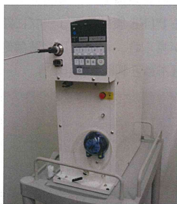
図 2：小型化した炭酸ガスレーザー装置
