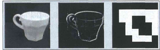
図 1-5. コーヒーカップを輪郭抽出(Sobel)し、2値の7×7に変換
