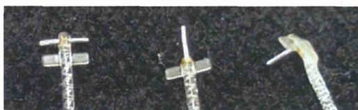
図6. 表面積が同じの3種類の帰還電極
