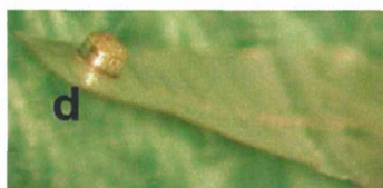
図4. 高さが0.3mmのSTS方式の刺激電極（直径は500um）（表面加工あり）
