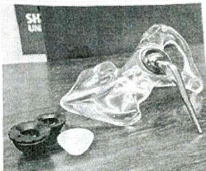
カーボンナノチューブを5%混入させた人工関節のモデル。白いものは従来のポリエチレン製。松本市の信州大本部で
