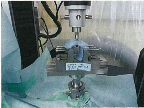
図 2-7 Push-Out 試験概要
