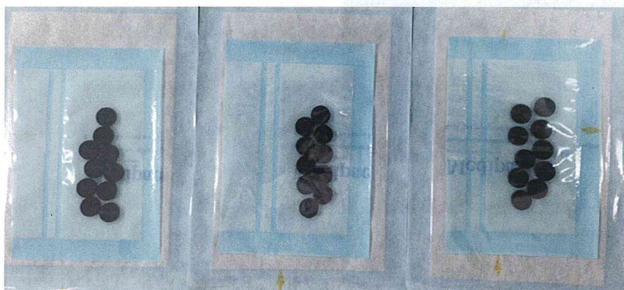
図 5-1 CNT 添加 PEEK 材 (CNT/PEEK) 左 3% 中 5% 右 7%
