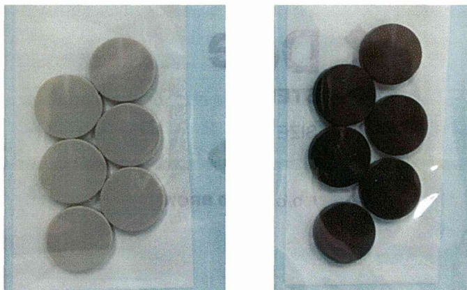
図 5-4 \phi 14mm の PEEK (左) と 7%CNT-PEEK (右)
