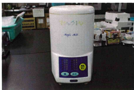
図1 クララ種子の傷処理に用いたマジックミル：型式 SKM-58
