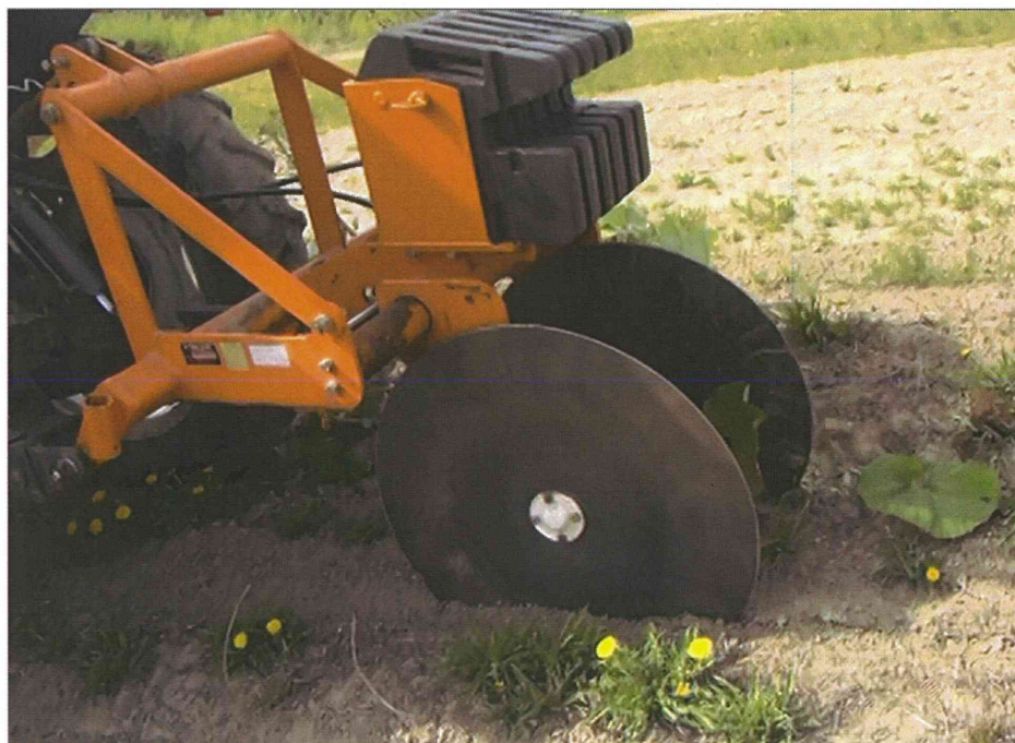
図1 試作コールタ型ストロン切断機 (作業機上にウェイト 290kg (45kg×6 枚) を搭載)
