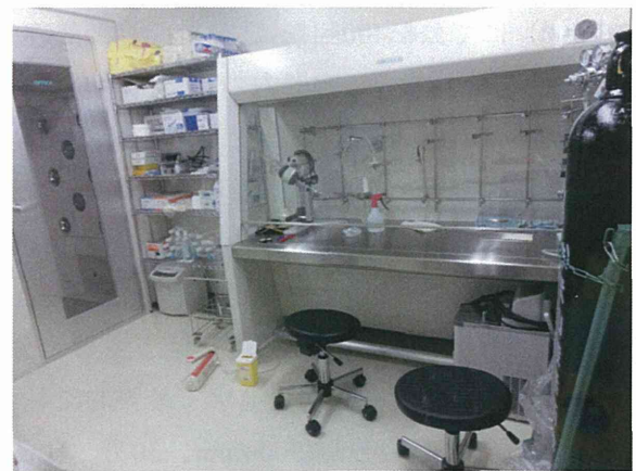
図 2. 人工赤血球調製用のクリーンブースとクリーンベンチ (奈良医大化学教室内)
