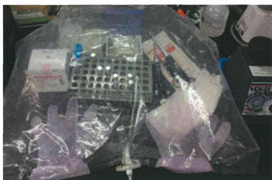
図13. クリーンバッグを用いたエンドトキシン測定システムの概観
