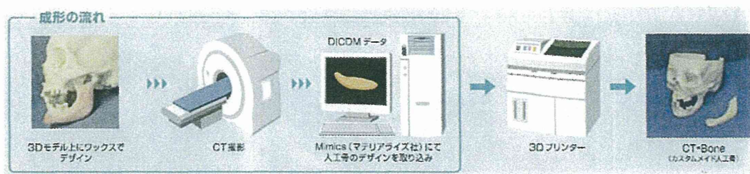
図2 カスタムメイド型人工骨 (CT-Bone) の作製過程
