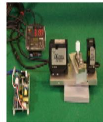
図6. クラウンの変位量測定器(全景)
