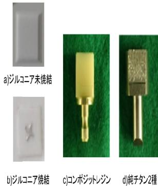
図4. 被切削材料の加工後の表面
