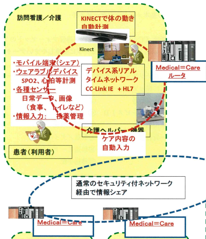
図7. 16 CC-Link IEによる各デバイスのリアルタイムネットワーク接続
