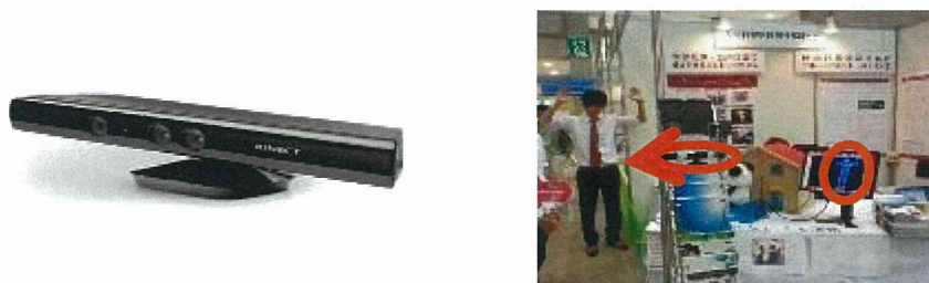
図7.12 KINECTによる体の動きの自動計測 (デバイス系リアルタイムネットワークに接続して共有)
