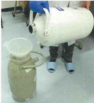
ドライシッパー準備 CXR100 (液体窒素充填)
