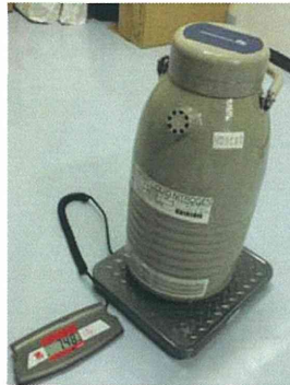
ドライシッパー準備 CXR100 (液体窒素充填)
