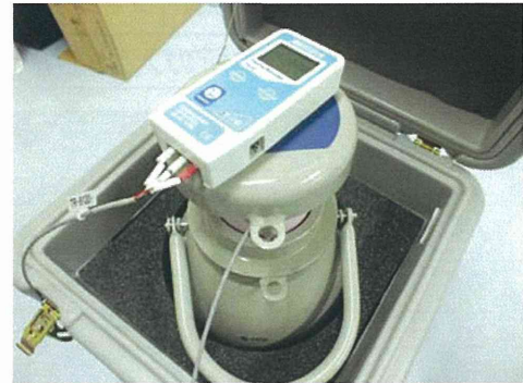
温度測定 容器内にセンサーを差し込み30分測定
