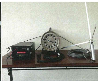
グランドプレーンアンテナと 高周波ケーブル・延長マイク コードの組み合わせ
